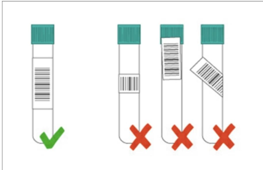
Abbildung 1 Etikettierung von Proben
